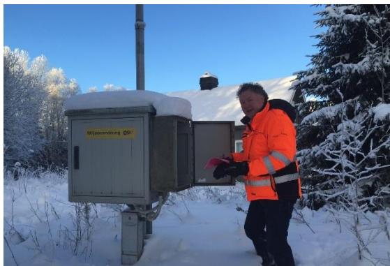
OSLs støy- og traséovervåkingsanlegg registrerer støynivået kontinuerlig på 11 punkter rundt flyplassen
