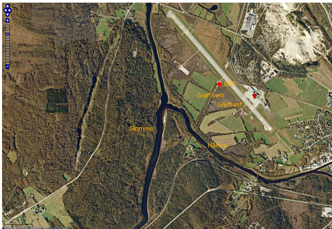
Figur 5-1. Oversiktsbilde over Røros flyplass med brannøvingsfelt (BØF), og grøftene drenerer fra brannøvingsfeltet og ut i Håelva og Glomma. Kilde: www.norgeskart.no .
