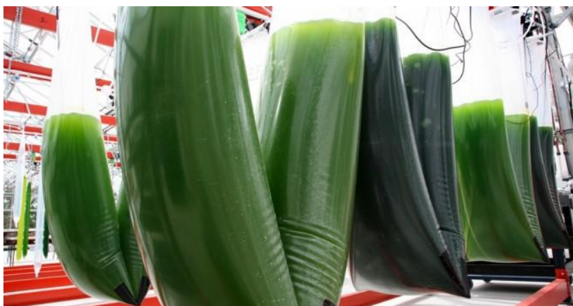
Figur 3-11 – Dyrkning av mikroalger i fotoreaktorer La Jolla, CA, USA © CVSG &amp; ExxonMobil
